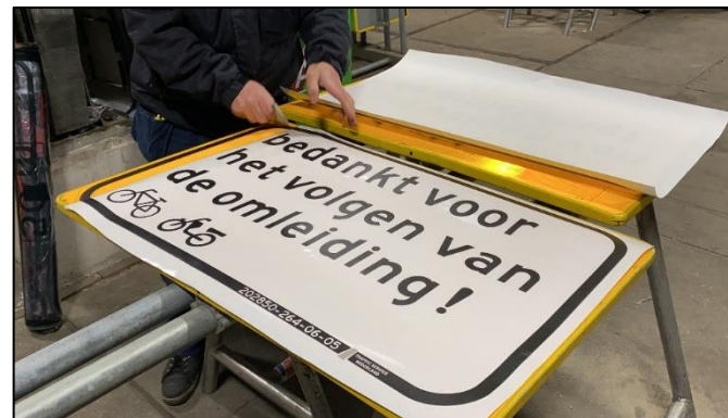
Figuur 44 – De tekst wordt uit de printer, op een reflectief onderbord geplakt
