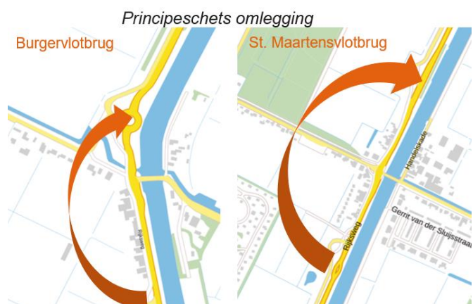
Afbeelding 5: Principeschets tracé om dorpskernen heen
