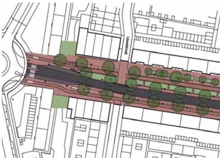
De uitvoering van de eerste fase van de herinrichting van de Lange Nieuwstraat is gestart. De gehele uitvoering is gereed in 2017. Er komt een versmald wegprofiel met vrijliggende fietspaden aan beide zijden van de weg.
